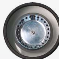
ROTOR PARA 36 MICROTUBOS, EM ALUMÍNIO DE LIGA ESPECIAL, 1,5 ml ou 2,0 ml.
